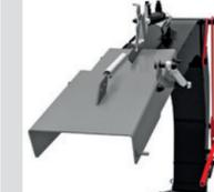
Längere Lebensdauer und geringerer Verschleiß durch widerstandsfähigen Stahl, Hardox. Genaue Auswurfsteuerung durch höhenverstellbares Auswurfrohr und doppelt einstellbarer Auswurfklappe.
