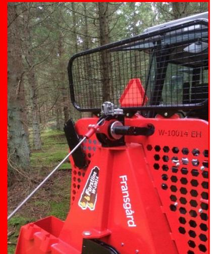
W-10014-EH mit optionalem hydraulischen Seilausstoss zum Abwickeln des Drahtseils ohne körperliche Anstrengung.
