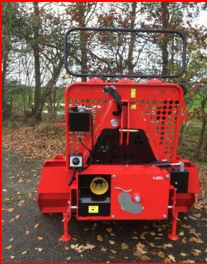
Mehrere Schutzgitter und ein „geräuschloser“ Kettenspanner garantieren gute und sichere Arbeitsbedingungen.
